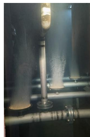
写真-1 散気ディスクの吹込状況
