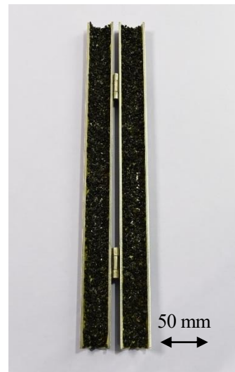
図2 半割加工した円筒リアクタ (活性炭を壁面に付着させた場合)
