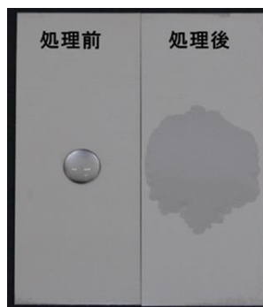
図2 純チタン板 表面の親水化
