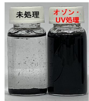
図3 カーボンブラック の水への分散(50日後)
